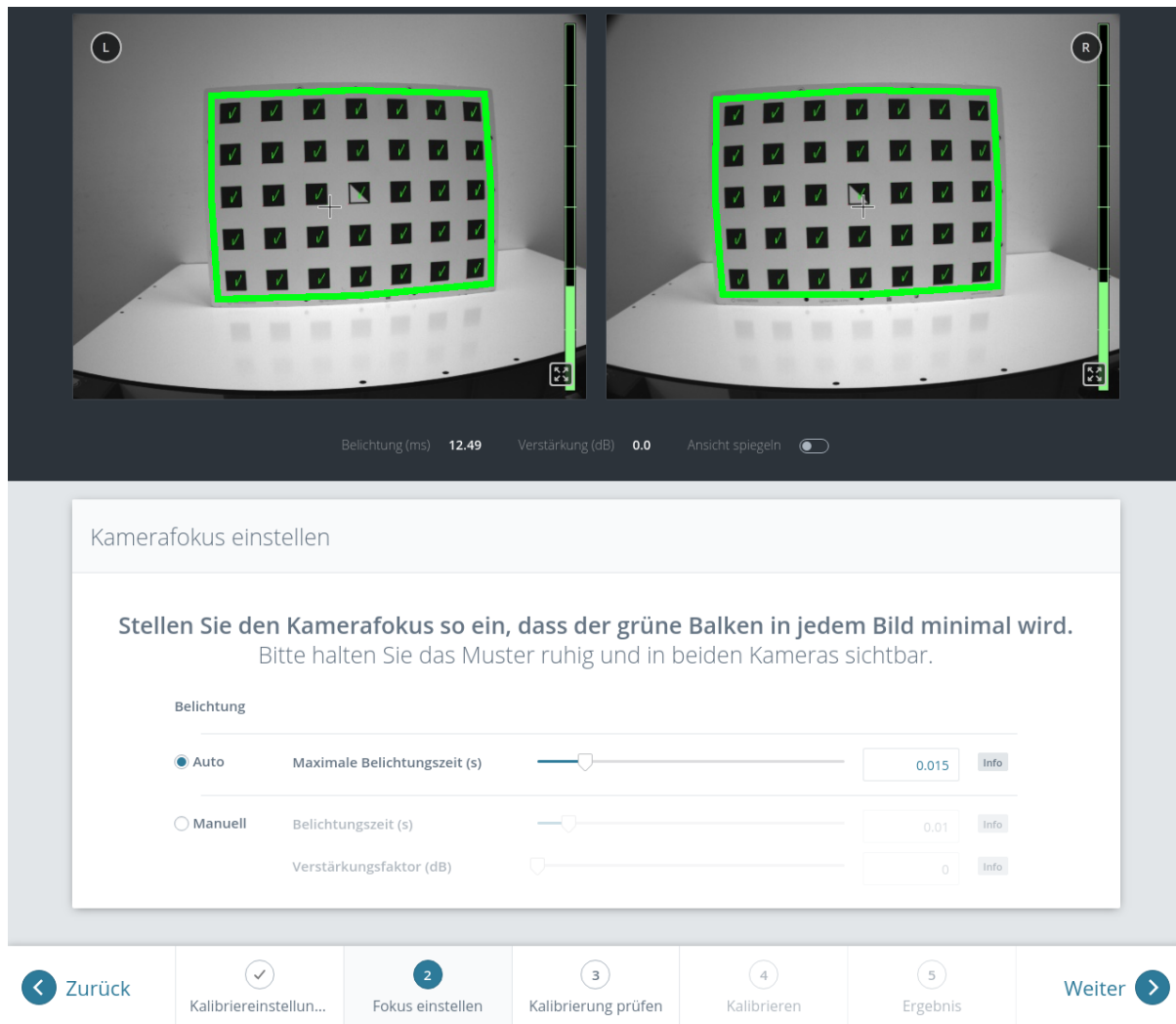
Abb. 6.28: Fokuseinstellung jeder Kamera
