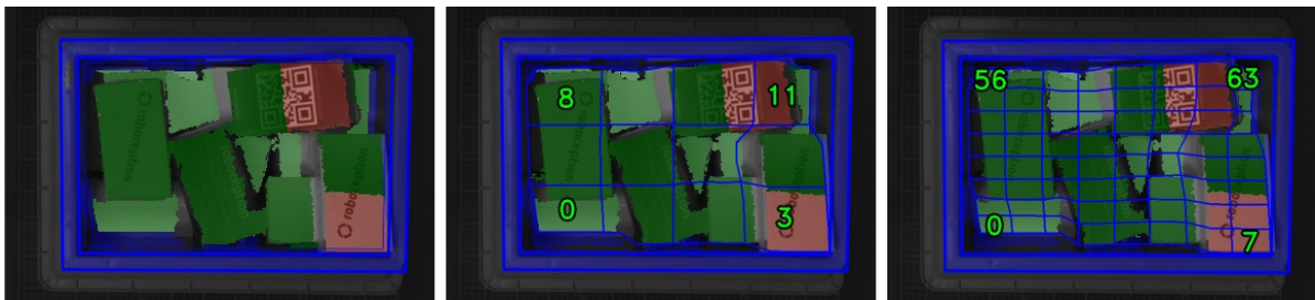
Abb. 6.5: Visualisierungen des Behälterfüllstands: Gesamtfüllstand ohne Raster (links), 4x3 Raster (Mitte), 8x8 Raster (rechts). Der Inhalt wird mit einem Farbverlauf von weiß (auf dem Boden) nach dunkelgrün dargestellt. Die überfüllten Bereiche sind rot dargestellt. Die Nummern stellen die Zell-IDs dar.
