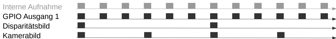
Abb. 6.35: Beispiel für die Nutzung der Betriebsart ExposureActive für GPIO-Ausgang 1 mit einer benutzerdefinierten Bildwiederholrate von 8 Hz. Die interne Bildaufnahme geschieht immer mit 25 Hz. GPIO-Ausgang 1 ist für die Dauer der Belichtungszeit jedes Bildes an (HIGH). Disparitätsbilder werden für Kamerabilder berechnet, die auch per GigE Vision in der benutzerdefinierten Bildwiederholrate versendet werden.
