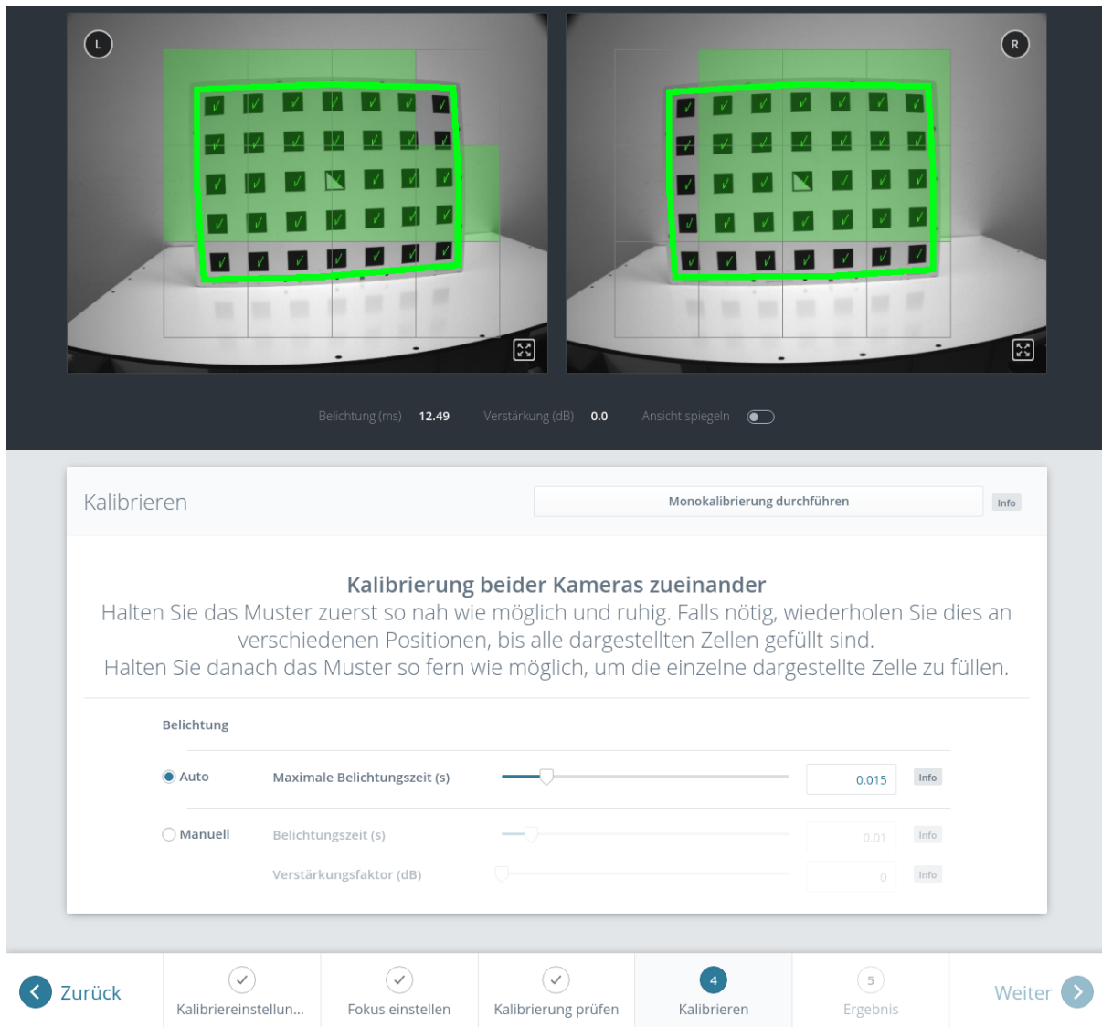
Abb. 6.32: Stereokalibrierung: Das Muster sollte so nah wie möglich gehalten werden, um alle dargestellten Zellen zu füllen.
