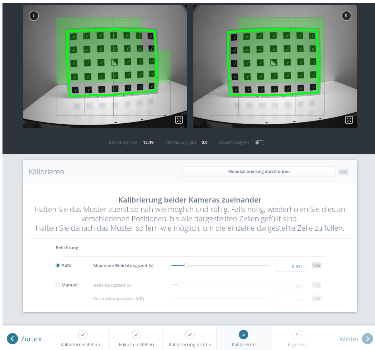
Abb. 6.31: Stereokalibrierung: Das Muster sollte so nah wie möglich gehalten werden, um alle dargestellten Zellen zu füllen.
