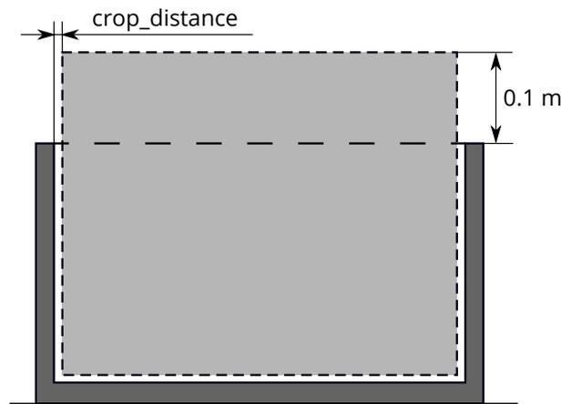
Abb. 6.38: Darstellung des Innenvolumens eines Load Carriers. Nur Punkte, die sich innerhalb dieses Volumens befinden, werden für Detektionen berücksichtigt.
