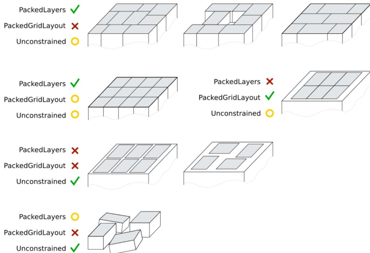
Abb. 6.13: Darstellung geeigneter BoxPick Modi für unterschiedliche Szenen. Gelb markierte Modi sind anwendbar, aber nicht empfohlen für das jeweilige Szenario. Die grauen Flächen markieren die Rechtecke, die erkannt werden sollen.
