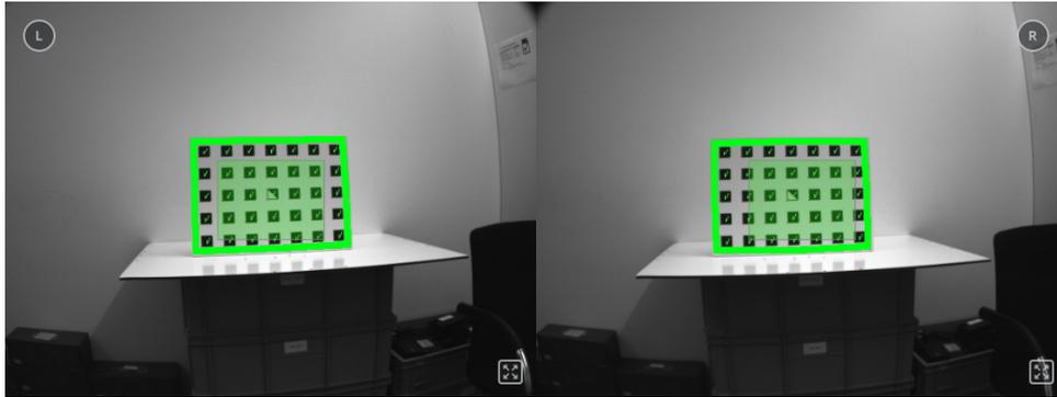
Abb. 6.32: Positionierung des Musters so entfernt wie möglich während der Stereokalibrierung
