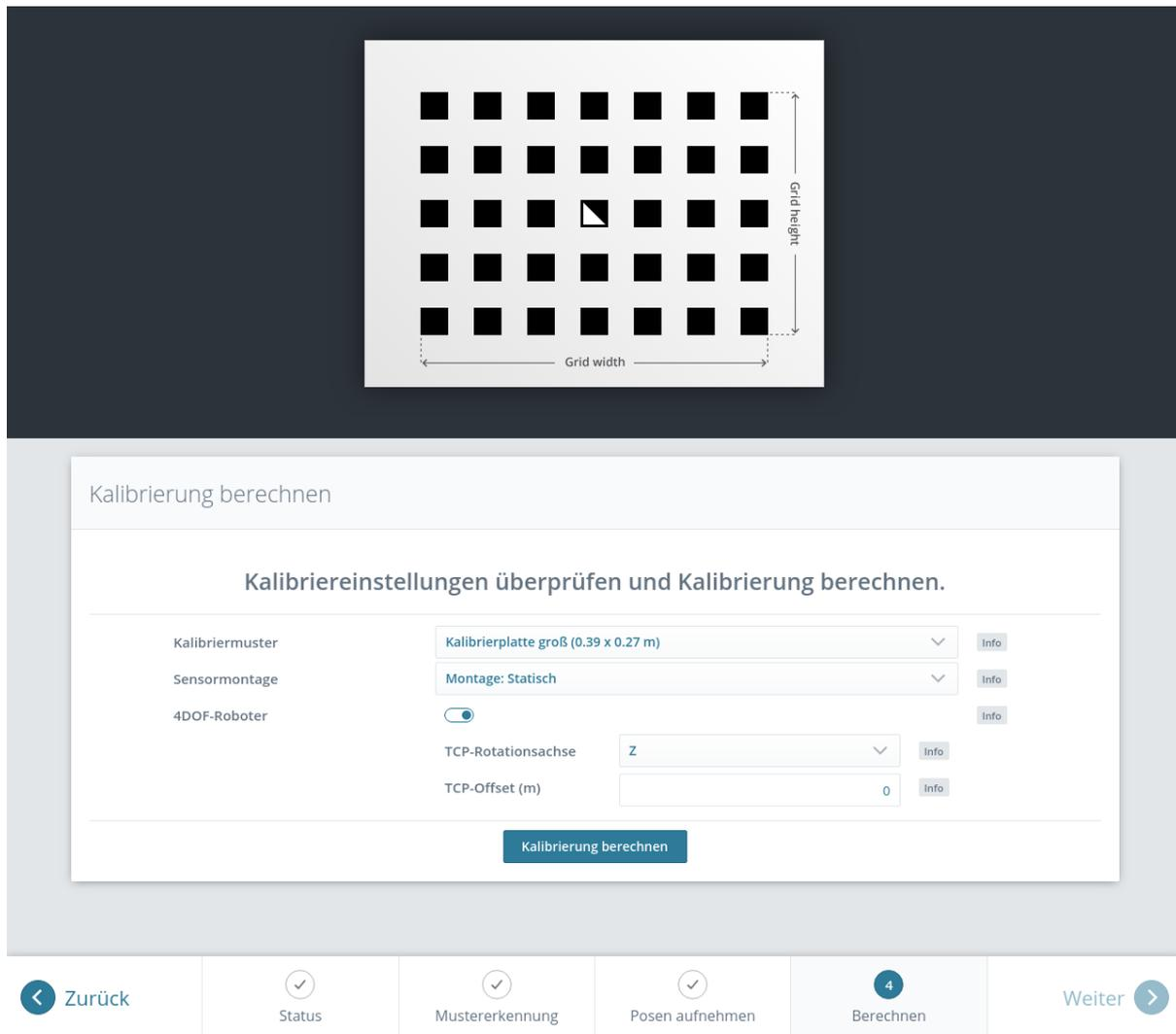
Abb. 6.25: Setzen der Parameter und Berechnen der Hand-Auge-Kalibrierung in der Web GUI des *rc\_cube*
