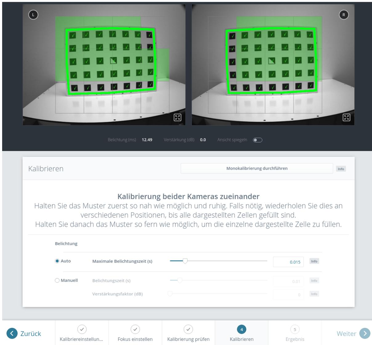
Abb. 6.31: Stereokalibrierung: Das Muster sollte so nah wie möglich gehalten werden, um alle dargestellten Zellen zu füllen.
