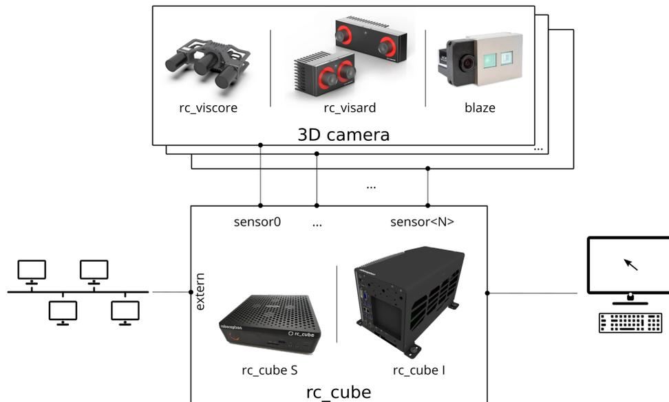
Abb. 1.1: Schematische Darstellung des *rc\_cube* und der angeschlossenen 3D Kameras. Falls nicht nur ein einziger *rc\_visard* am *rc\_cube S* angeschlossen wird, benötigt man einen separaten 2.5Gbit Switch.
