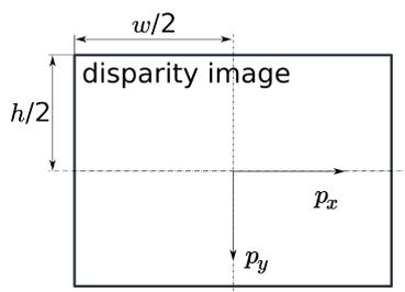
Abb. 6.3: Bildkoordinatensystem: Der Ursprung des Bildkoordinatensystems befindet sich in der Bildmitte –  $w$  ist die Bildbreite und  $h$  die Bildhöhe.
