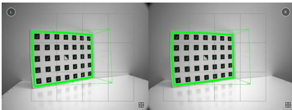
Abb. 6.30: Pfeile weisen darauf hin, wenn das Muster während der Stereokalibrierung nicht senkrecht zur Blickrichtung der Kamera gehalten wird.
