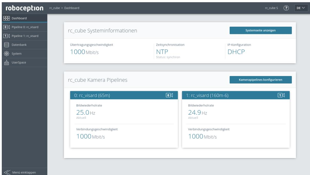
Abb. 7.1: Dashboard-Seite der Web GUI des *rc\_cube*
