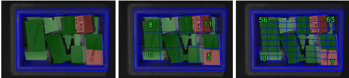
Abb. 6.6: Visualisierungen des Behälterfüllstands: Gesamtfüllstand ohne Raster (links), 4x3 Raster (Mitte), 8x8 Raster (rechts). Der Inhalt wird mit einem Farbverlauf von weiß (auf dem Boden) nach dunkelgrün dargestellt. Die überfüllten Bereiche sind rot dargestellt. Die Nummern stellen die Zell-IDs dar.
