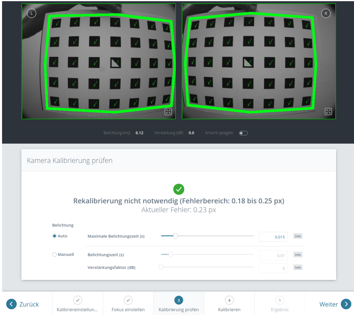
Abb. 6.30: Überprüfung der Kalibrierung
