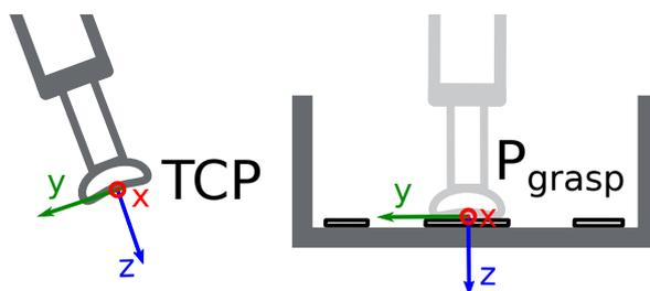
Abb. 6.14: Definition von Greifpunkten bezogen auf den Roboter-TCP
