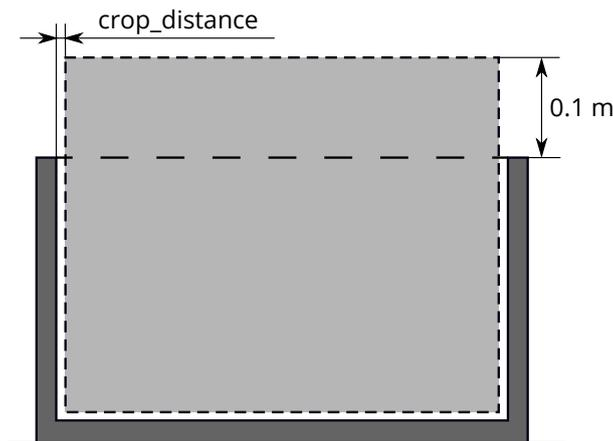
Abb. 6.39: Darstellung des Innenvolumens eines Load Carriers. Nur Punkte, die sich innerhalb dieses Volumens befinden, werden für Detektionen berücksichtigt.
