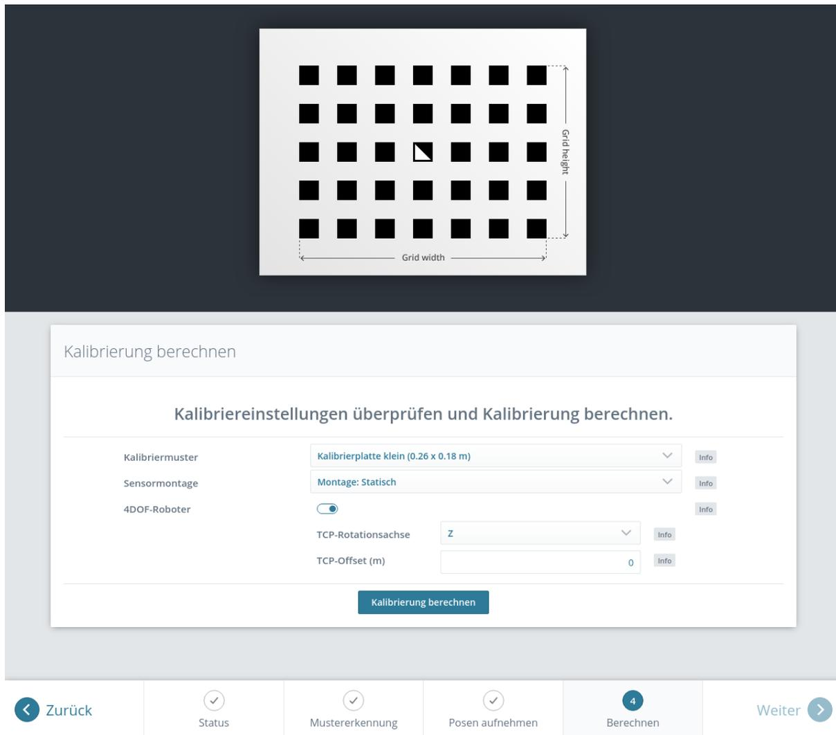
Abb. 6.26: Setzen der Parameter und Berechnen der Hand-Auge-Kalibrierung in der Web GUI des *rc\_cube*
