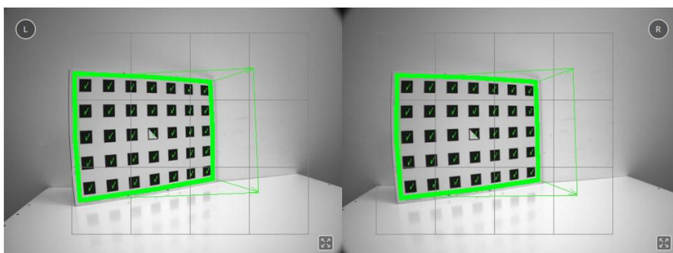
Abb. 6.31: Pfeile weisen darauf hin, wenn das Muster während der Stereokalibrierung nicht senkrecht zur Blickrichtung der Kamera gehalten wird.
