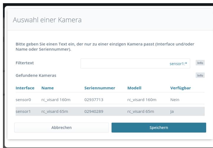
Abb. 5.4: Auswahl der Kamera durch Setzen eines Filtertexts
