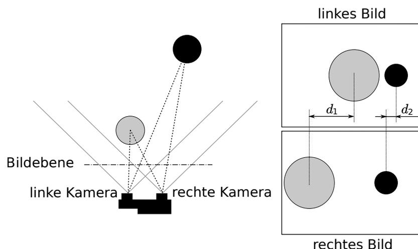
Abb. 4.1: Schematische Darstellung des Prinzips der Stereovision: Die Disparität  $d_2$  des weiter entfernten (schwarzen) Objekts ist kleiner als die Disparität  $d_1$  des nahe liegenden (grauen) Objekts.
