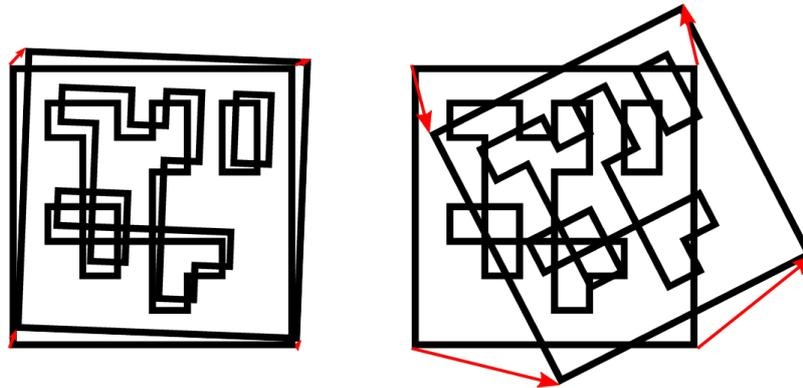
Abb. 6.11: Vereinfachte Darstellung der Tag-Wiedererkennung. Die euklidischen Abstände zwischen zusammengehörigen Tagecken in 3D werden berechnet (rote Pfeile).
