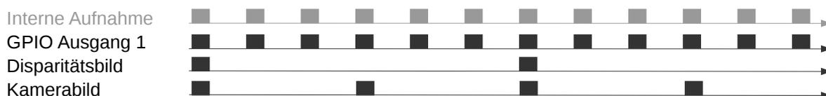
Abb. 6.36: Beispiel für die Nutzung der Betriebsart ExposureActive für GPIO-Ausgang 1 mit einer benutzerdefinierten Bildwiederholrate von 8 Hz. Die interne Bildaufnahme geschieht immer mit 25 Hz. GPIO-Ausgang 1 ist für die Dauer der Belichtungszeit jedes Bildes *an* (HIGH). Disparitätsbilder werden für Kamerabilder berechnet, die auch per GigE Vision in der benutzerdefinierten Bildwiederholrate versendet werden.
