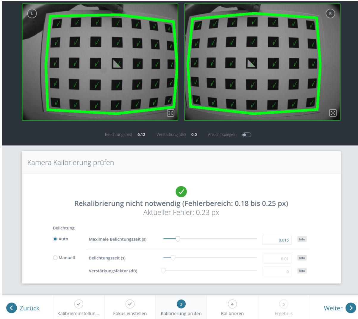
Abb. 6.30: Überprüfung der Kalibrierung
