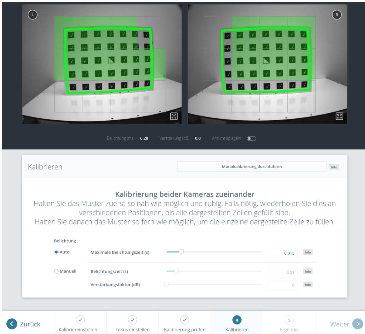
Abb. 6.32: Stereokalibrierung: Das Muster sollte so nah wie möglich gehalten werden, um alle dargestellten Zellen zu füllen.
