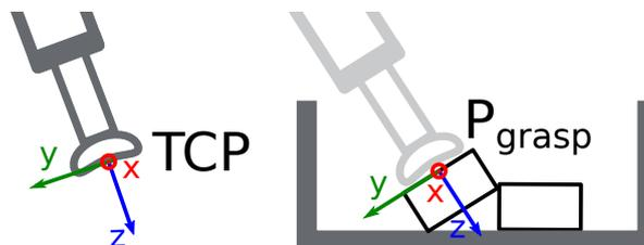
Abb. 6.16: Definition von Greifpunkten bezogen auf den Roboter-TCP
