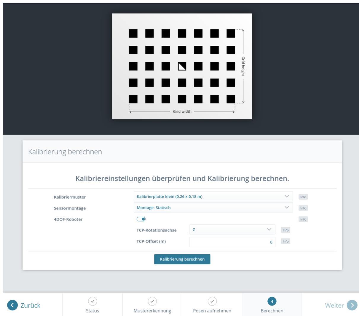
Abb. 6.27: Setzen der Parameter und Berechnen der Hand-Auge-Kalibrierung in der Web GUI des *rc\_cube*
