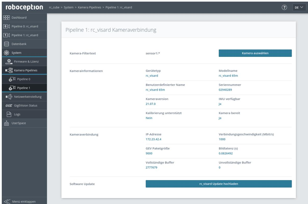
Abb. 5.3: Konfigurieren der Kameraverbindung von Pipeline 1
