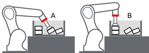
Abb. 6.43: Fall A: Der Griff wird nur als Kollision erkannt, wenn `check_flange` auf `true` gesetzt ist, denn der Flansch (rot) befindet sich im Load Carrier. Fall B: Der Griff ist in jedem Fall kollisionsfrei.
