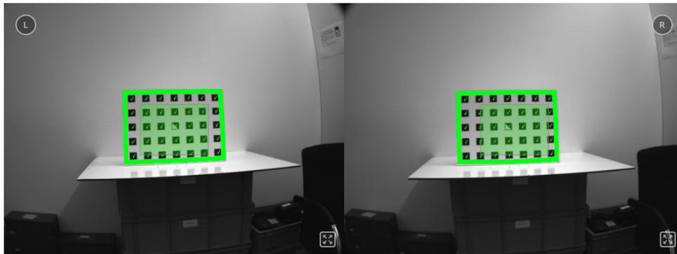
Abb. 6.34: Positionierung des Musters so entfernt wie möglich während der Stereokalibrierung
