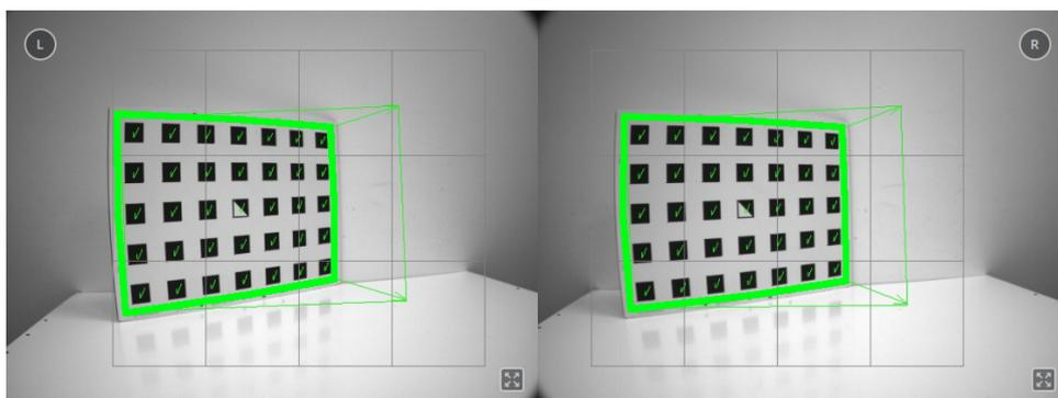
Abb. 6.32: Pfeile weisen darauf hin, wenn das Muster während der Stereokalibrierung nicht senkrecht zur Blickrichtung der Kamera gehalten wird.
