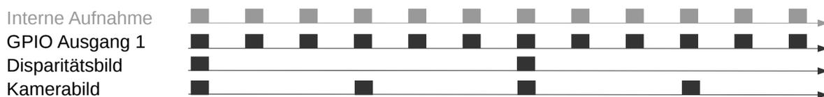
Abb. 6.37: Beispiel für die Nutzung der Betriebsart ExposureActive für GPIO-Ausgang 1 mit einer benutzerdefinierten Bildwiederholrate von 8 Hz. Die interne Bildaufnahme geschieht immer mit 25 Hz. GPIO-Ausgang 1 ist für die Dauer der Belichtungszeit jedes Bildes *an* (HIGH). Disparitätsbilder werden für Kamerabilder berechnet, die auch per GigE Vision in der benutzerdefinierten Bildwiederholrate versendet werden.
