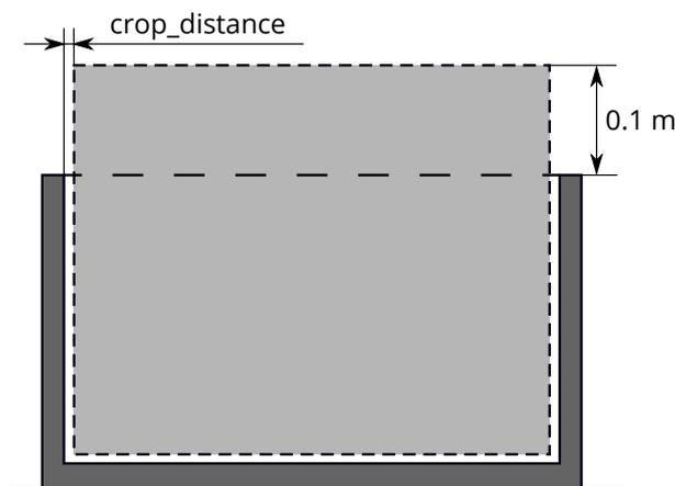
Abb. 6.40: Darstellung des Innenvolumens eines Load Carriers. Nur Punkte, die sich innerhalb dieses Volumens befinden, werden für Detektionen berücksichtigt.
