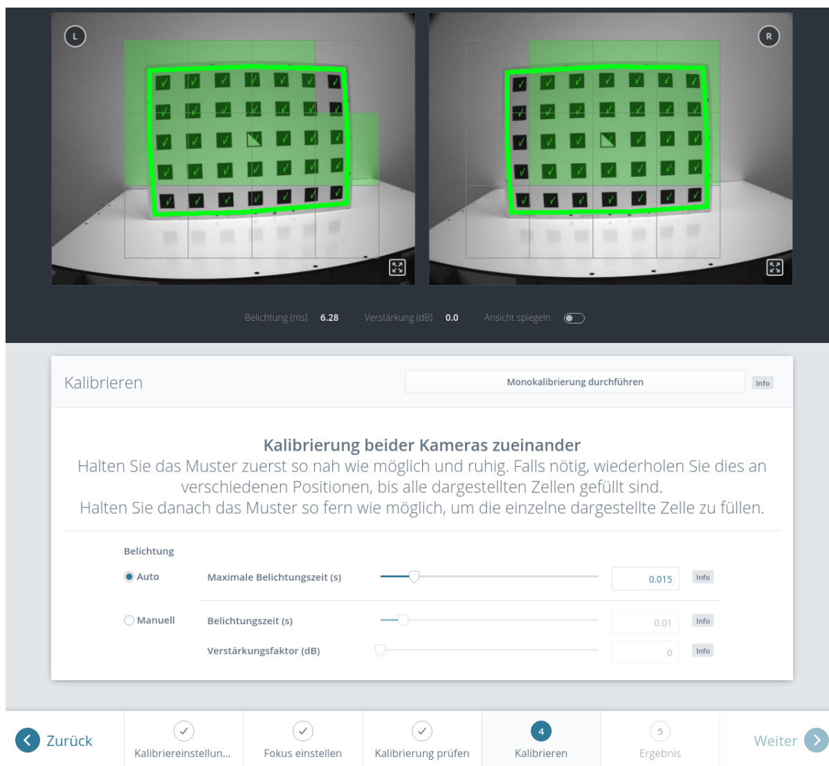
Abb. 6.33: Stereokalibrierung: Das Muster sollte so nah wie möglich gehalten werden, um alle dargestellten Zellen zu füllen.
